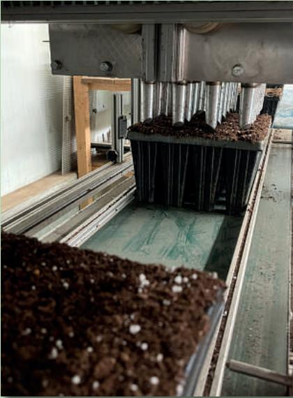
Maschinelle Befüllung der QuickPot Platten mit eigener Erdmischung und Vorstanzen der Topflöcher
